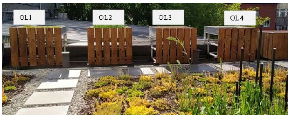
Рис. 2. Макеты зеленых кровель [Fig. 2. Green roof installations]
